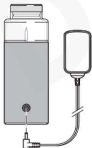
1. Schließen Sie den Netzadapter an die Anschlussbuchse des Gerätes an.
